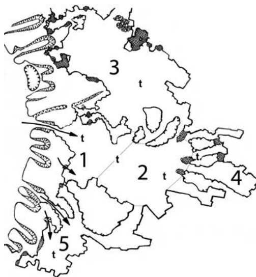
Рис. 1. Абрис штольни Ледяная. Зоны пещеры: 1 – привходовая часть большого колонного зала, 2 – глубокая часть того же зала, 3 – ручьевого зала, 4 – штреки, 5 – южный отсек. Стрелками обозначены действующие входы; t – точки измерения температуры и влажности.
